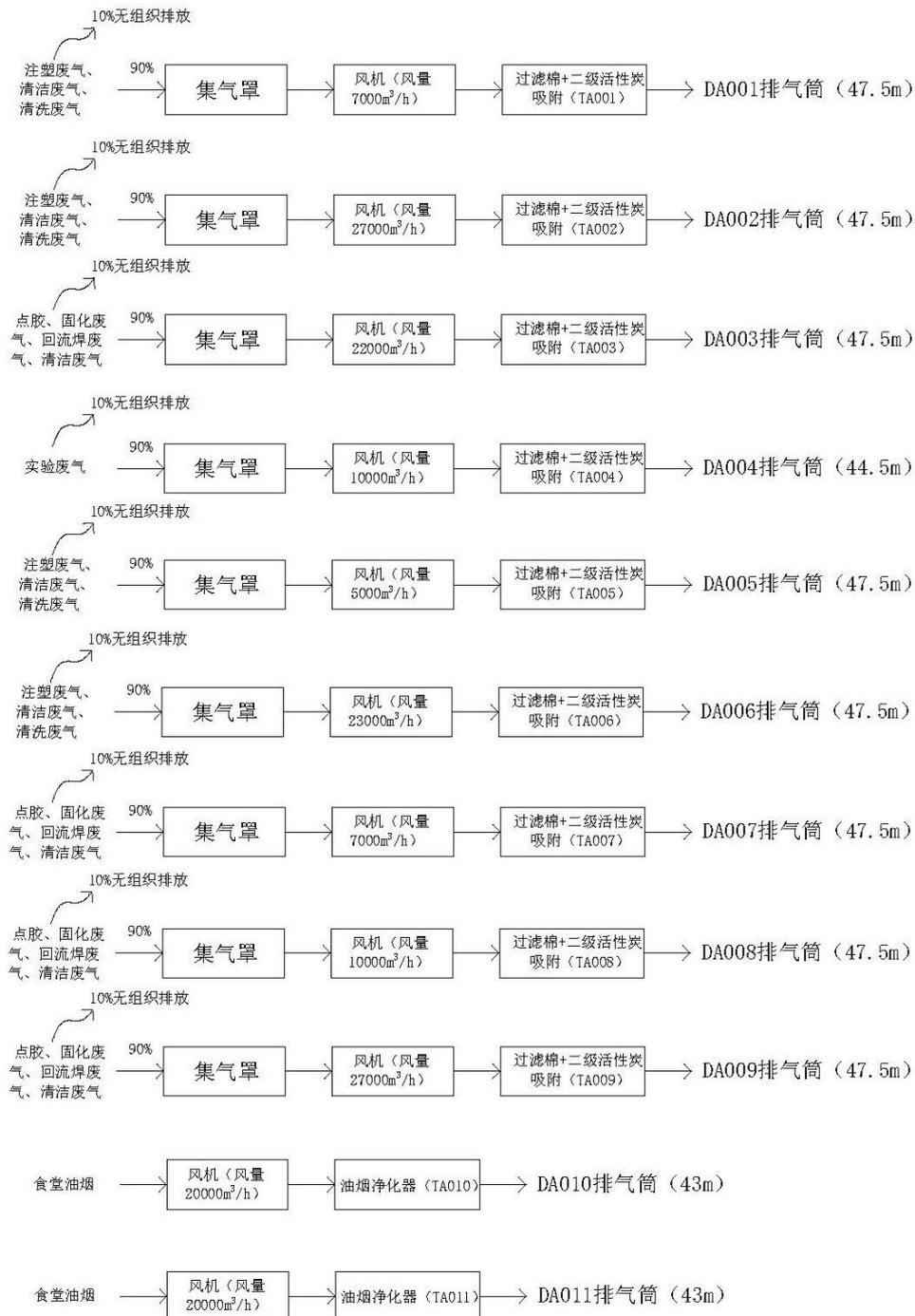
图 4-1 废气处理流程图
